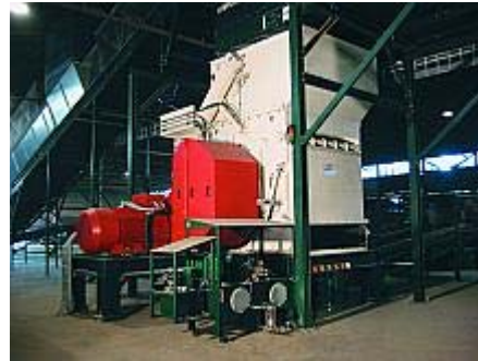
Einwellenzerkleinerer WFC 2000/1200 für die Nachzerkleinerung von Ersatzbrennstoffen Foto: Weima
