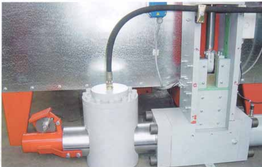
Die Brikettierpressen der Baureihe »TH 400-TH 700« wurden von WEIMA weiterentwickelt und verfügen nun über ein neues Zangensystem.
