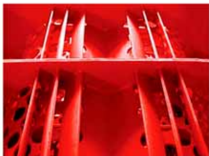
Litwy łamania średniego zapobiegają powstawaniu długich elementów (wstęg)
