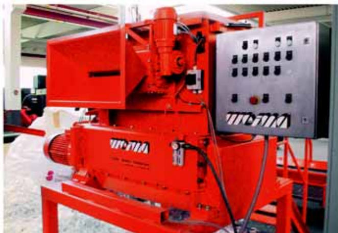
Kruszarka ZMK z przenośnikiem rolkowym
