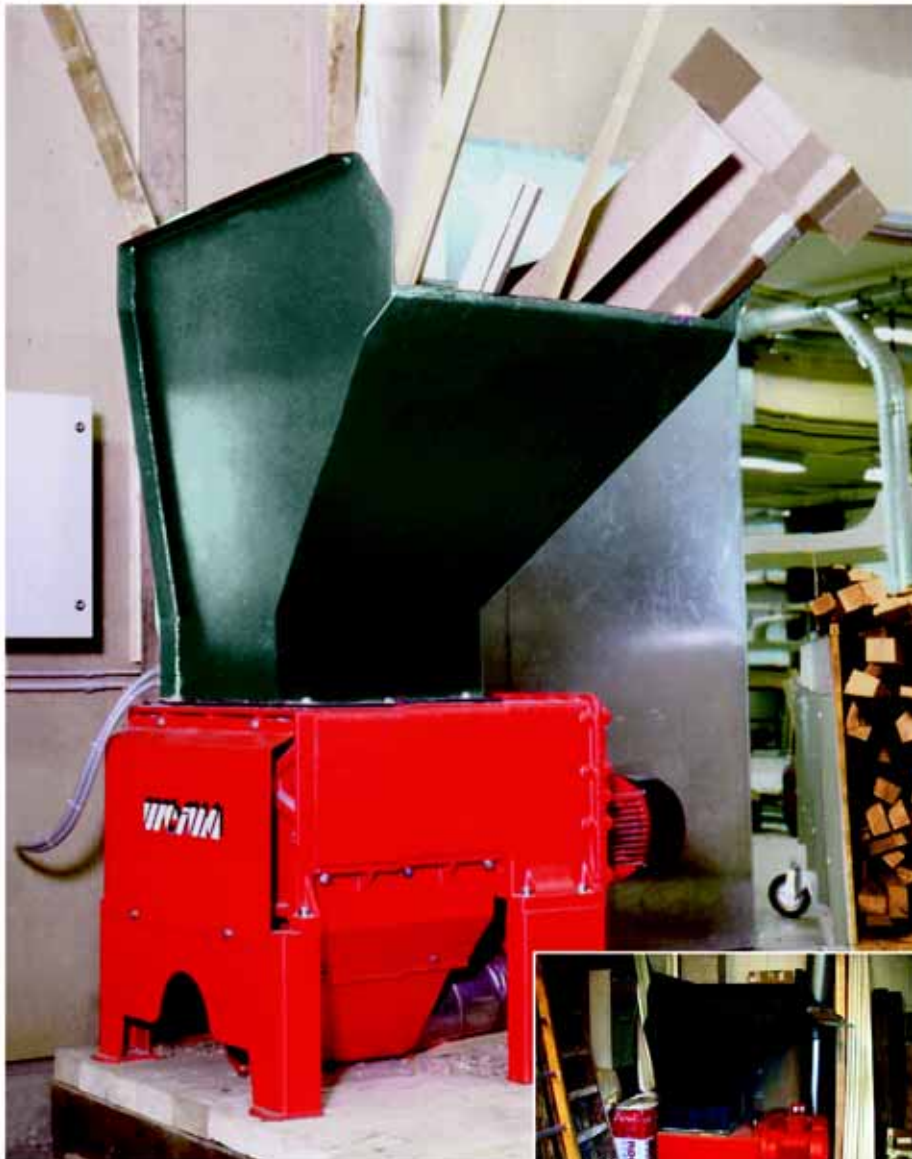
Zastosowanie w stolarni: Rębak czterowalowy serii ZM 30 z pełnym lejem
