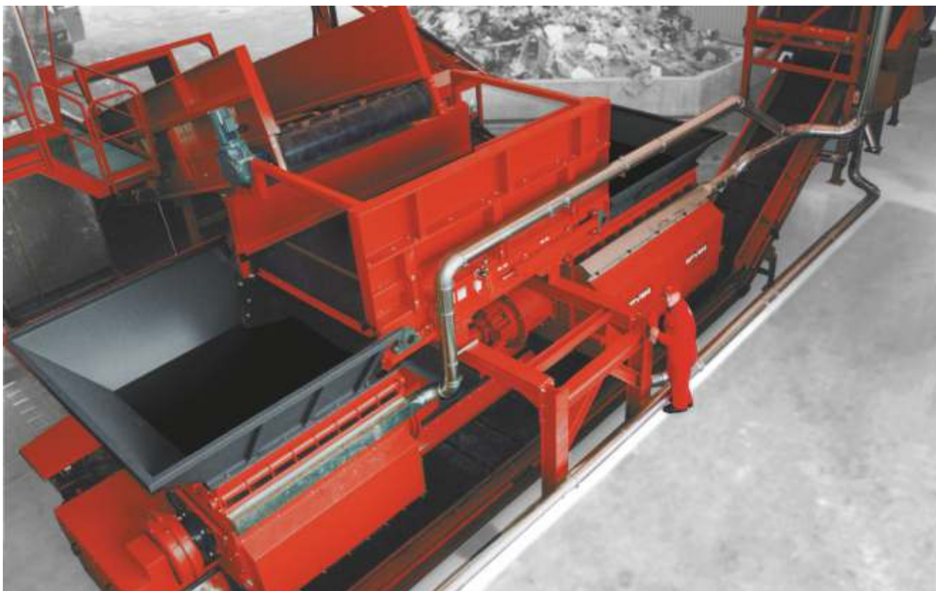
Kombinacja WLK 30 z napędem hydraulicznym i WLK 20 Super-Jumbo z napędem mechanicznym, XO-Group (Finlandia) WLK 30 с гидравлическим приводом и WLK 20 Super-Jumbo с электро приводом, XO-Group (Финляндия))
