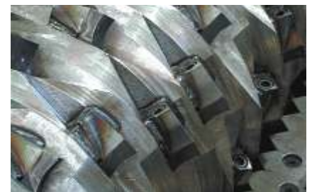
Rotor en V, double rangées de couteaux
