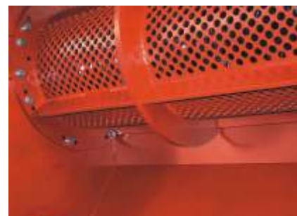
Le Ø des trous du tamis détermine la grosseur du broyat
