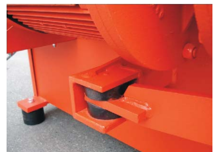
Gegenhalter für Getriebe Holding block for gear box
