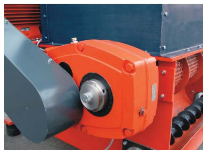
Getriebe und Keilriemen Gear box and v-belts
