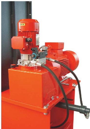
Hydraulikeinheit für Schieber Hydraulic unit for the pusher
