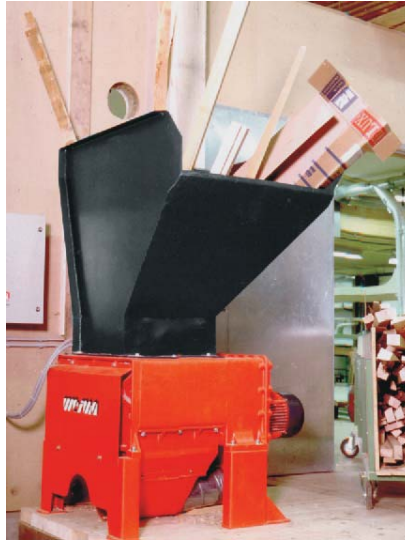
Einsatz in einer Schreinerei: 4-Wellenzerkleinerer der Baureihe ZM 30 mit gefülltem Trichter
