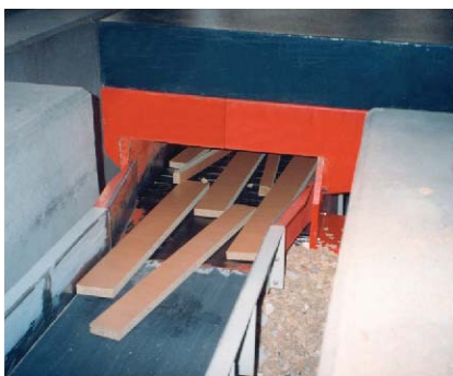
LEOPARD in der Grube direkt an der Plattenaufteilsäge
