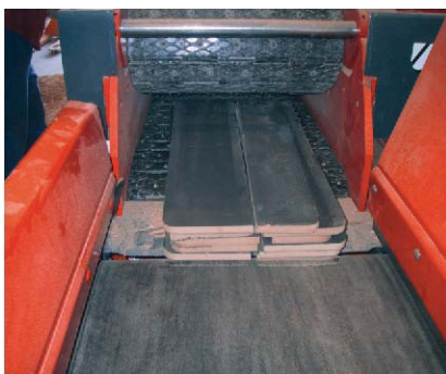
Gliederketteneinzug für Restholz- und Spanplattenstapel
