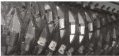
Minimaler Verschleiß: der PowerLine Rotor mit mehrfach wendbaren Messern.
